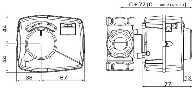
Установочные размеры для контроллеров серии CRC140 со смесительными клапанами ESBE VRG100, VRG200, VRG300, VRH100 и VRB100
